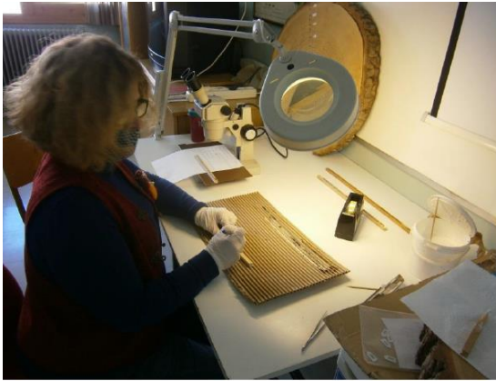
Διασταυρούμενη χρονολόγηση τρυπανιδιών δρυός (φωτ. Παπαδόπουλος Α.) Μέτρηση πλατών δακτυλίων με το σύστημα Windendro (φωτ. Παπαδόπουλος Α.)
